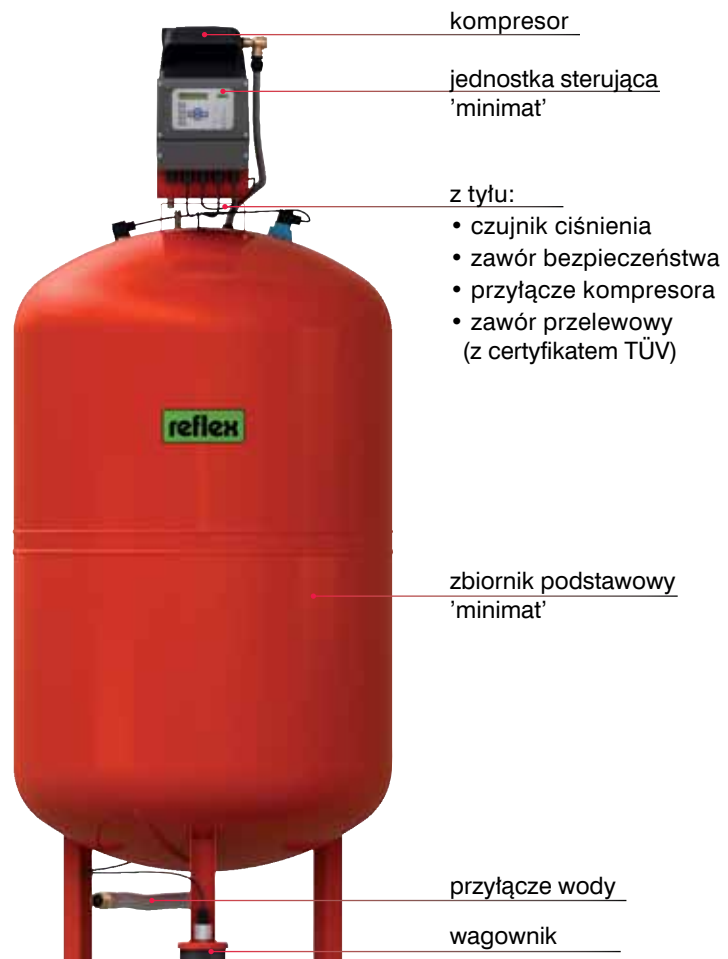
reflex 'minimat': stabilizacja ciśnienia w precyzyjnych granicach (+/- 0,1 bar)
